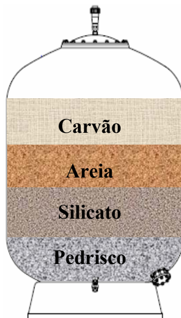
Figura 3.11 – Corte Lateral de um Filtro Multimeios, Mostrando as Camadas Filtrantes
